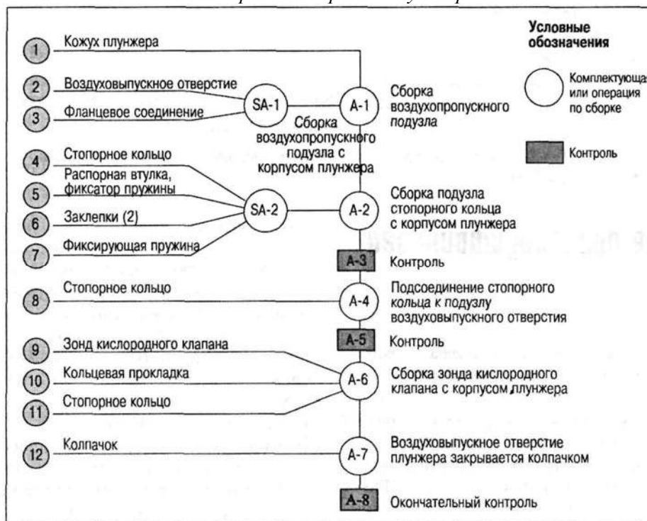
Рис. 4.12. Схема сборки плунжера насоса
